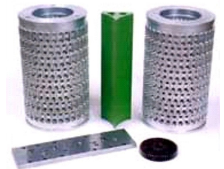
Abb. 1: Beispiel von Formwalzen für die großtechnische Herstellung von Weichkapseln
