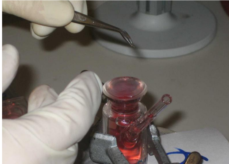
Abb. 4: Die RHE (EpiDerm™) wurde aus dem Insert herausgeschnitten und auf die Oberseite der Franzzelle mit Hilfe einer Pinzette zentriert. Die Stratum-corneum-Seite hat Kontakt zur Luft (Donorseite), die Hautunterseite mit dem Akzeptormedium (rötlich gefärbt).
