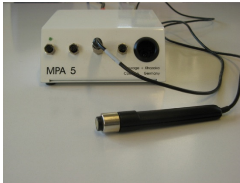
Abb.1: Corneometer CM 825 angeschlossen an einen Multi Probe Adapter (Courage und Khazaka Electronic GmbH, Köln) (links). Messung der Hautfeuchtigkeit am Unterarm einer Probandin (rechts).
