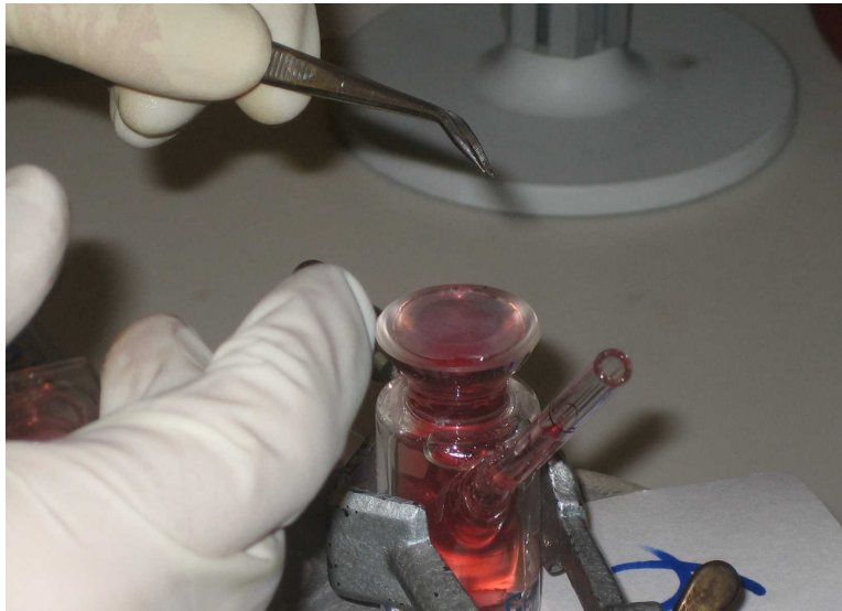
Abbildung 4: Die RHE (EpiDerm™) wurde aus dem Insert herausgeschnitten und auf die Oberseite der Franzelle mit Hilfe einer Pinzette zentriert. Die Stratum-corneum-Seite hat Kontakt zur Luft (Donorseite), die Hautunterseite mit dem Akzeptormedium (rötlich gefärbt).
